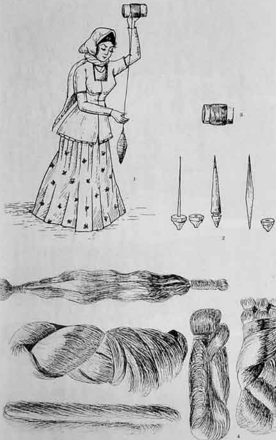
İpəktovlama alətləri: 1-əl iyi vasitəsi ilə ipəktovlama; 2-əl iyləri; 3-sargı; 4-ipək kələfləri (qəcil).
